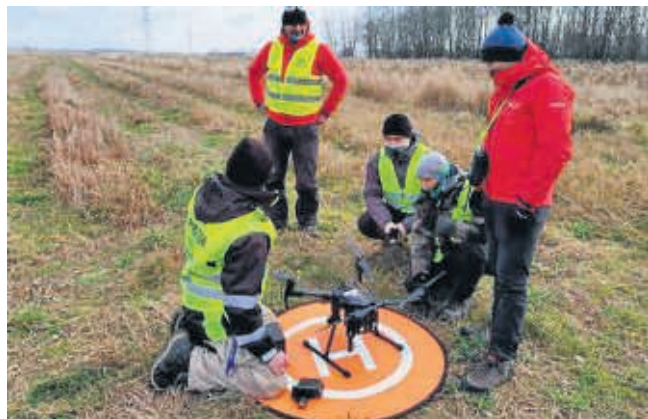
Dzięki termowizyjnej kamerze w dronie strażacy będą w stanie bardzo dokładnie określić źródło pożaru
